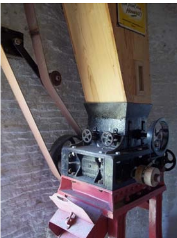
In de aandrijving van de haverpletter zijn twee lagers vervangen
